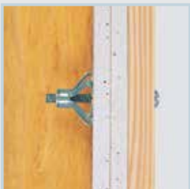
مهار جمع شونده فلزی (دیوار دو لایه)
