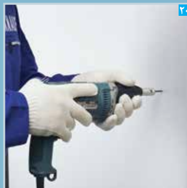
نحوه صحیح در دست گرفتن پیچ زن (به صورت عمود بر پنل)
